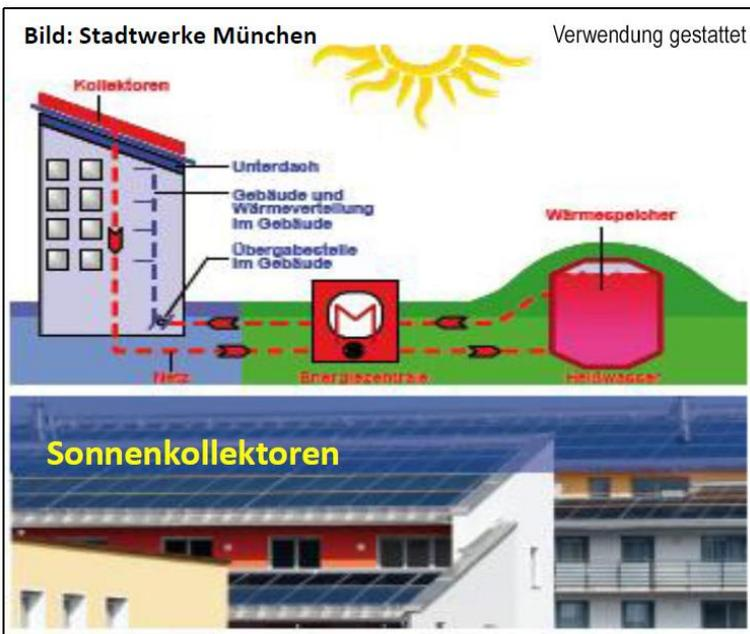
In **Sonnenkollektoren** ist in Röhren Wasser enthalten. Dieses wird von der **Sonnenenergie erwärmt**. Das erwärmte Wasser wird in einen **Speicher** gepumpt und überträgt die Wärme auf das Wasser des Speichers. Aus diesem kann das **warme Wasser** z. B. zum Duschen und Baden verwendet werden. Am Ackermannbogen sind die Wärmespeicher besonders groß, sodass auch im Winter warmes Wasser zur Verfügung steht. 40% des warmen Wassers wird dort von der Sonne erwärmt.
